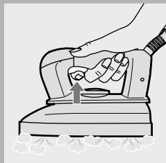
Sólo modelos GC6024 y GC6026: Durante el planchado con vapor, el piloto de temperatura (G) se iluminará de vez en cuando para indicar que la plancha y el agua del depósito de vapor se están calentando hasta alcanzar la temperatura y presión adecuadas. Puede seguir planchando mientras esto suceda.
