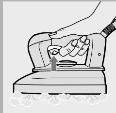
Solo mod. GC6024/6026: durante la stiratura a vapore, la spia (G) si accenderà di tanto in tanto per indicare che il ferro e l'acqua nel serbatoio si stanno riscaldando per raggiungere la temperatura e la pressione corrette. Quando ciò accade, potete comunque continuare a stirare.
