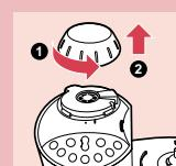
**1** Pour attacher le bol mixer, enlevez le capuchon de sécurité situé au dessus du panneau de commande.
