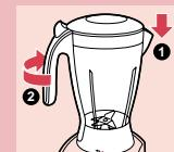
**2** Montez le bol mixer sur le bloc moteur en le tournant dans la direction de la flèche jusqu'à ce qu'il soit fermement fixé. La poignée doit être dirigée vers la gauche.
