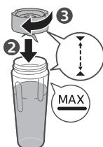
**5** Otočením nožové jednotky ve směru hodinových ručiček ji připevněte k lahvi.
