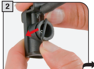
Den neuen O-Ring durch sanften Druck einsetzen.
