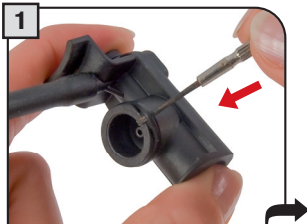
Den O-Ring unter Verwendung eines spitzen Gegenstandes entfernen.
