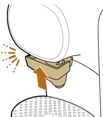
**5** Riposizionate il beccuccio di erogazione del caffè e spingetelo nell'alloggiamento della macchina finché non scatta in posizione.
