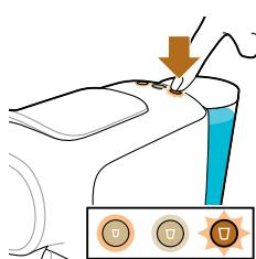
Hinweis: Der Wasserbehälter wird ohne Unterbrechung entleert. Der Spülvorgang dauert ca. 3 Minuten.
