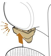
**5** Schieben Sie den Kaffeeauslauftrichter wieder ein und drücken Sie ihn in das Gehäuse der Maschine, bis er einrastet.
