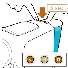
6 Houd de ristrettoknop en de lungoknop 3 seconden tegelijkertijd ingedrukt. De ristrettoknop begint te knipperen en de lungoknop brandt normaal.
