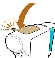
**Avvertenza: evitate di inserire le dita nello scomparto di erogazione quando chiudete la leva per evitare lesioni. All'interno della leva è presente un perforatore affilato invisibile.**
