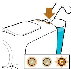
Remarque : le réservoir d'eau se videra sans interruption. Le cycle de rinçage dure environ 3 minutes.
