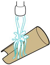
**2** Reinigen Sie den Wasserbehälter unter fließendem, warmem Wasser.
