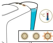
5 La machine chauffe en 25 secondes environ et commence le rinçage. L'eau s'écoule de la buse de distribution du café dans le bol et s'arrête de couler quand le circuit d'eau interne est rempli.
