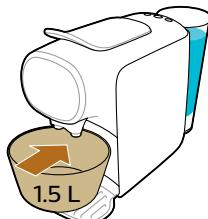
**5** Coloque um recipiente com uma capacidade mínima de 1,5 litros no tabuleiro de recolha de pingos inferior sob o bico de distribuição do café para recolher a solução de descalcificação.
