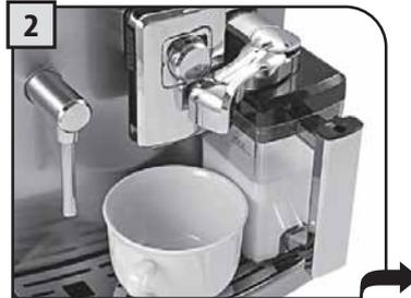
2 Girar la parte superior del mango del contenedor en la taza. Para evitar que la leche rebose, utilizar siempre una taza de dimensiones adecuadas.
