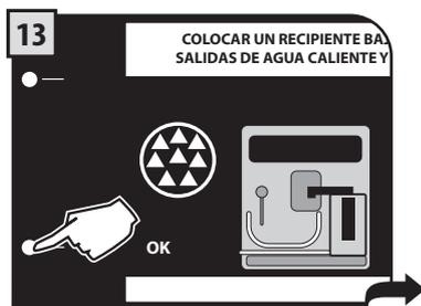
Colocar un recipiente debajo de la salida de café y un contenedor debajo del tubo de agua caliente. A continuación, pulsar el botón "OK".
