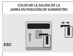
Se ha seleccionado una bebida con leche. La máquina solicita posicionar la boquilla del mango de la jarra en la posición de suministro.
