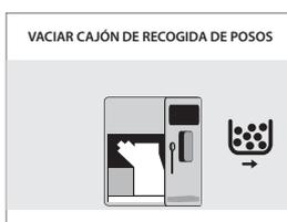
Extraer el cajón de recogida de posos y vaciar los posos en un contenedor adecuado.
