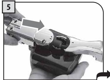
5 Insertar la protección externa. Debe ser introducida en las guías de la base.
