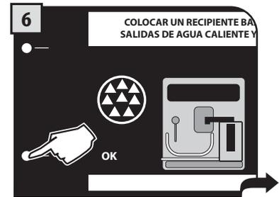
Colocar un recipiente debajo de la salida de café y un contenedor debajo del tubo de agua caliente. A continuación, pulsar el botón "OK".
