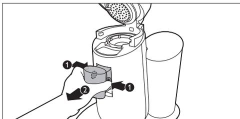
**5** Pour démonter parties intérieures du bec verseur, saisissez les deux clavettes de la partie intérieure de l'unité d'écoulement et serrez-les légèrement (1). Déplacez la partie intérieure vers le bas pour la retirer de la partie extérieure de l'unité d'écoulement (2).
