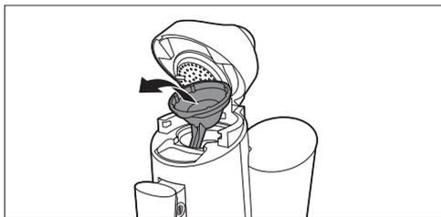
**4** Pour retirer le bec verseur du café, appuyez sur les boutons de déverrouillage (1) et retirez le bec verseur du café de la machine (2).
