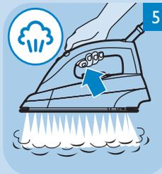
**5** Wenn Sie mit Dampf bügeln möchten, stellen Sie den Temperaturregler des Bügeleisens auf ●● oder höher und drücken Sie die Dampftaste **T**.
