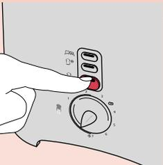
**5** İstenilen kızartma ayarını seçiniz, cihazı çalıştırmak için kızartma kolu aşağıya itiniz ve **U** düğmesine basınız.
