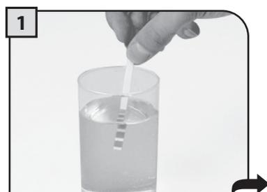
Plonger dans l'eau la bande de test fournie avec la machine pendant une seconde, afin de vérifier la dureté de l'eau.
