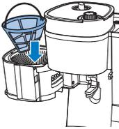
3 Встановіть фільтр у кошик фільтра.
