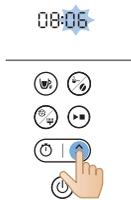
4 Då börjar minutindikeringen att blinka. Använd pilknappen för att ändra minutinställning.
