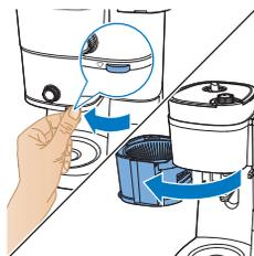
5 Placez le filtre dans le porte-filtre et fermez le support pour porte-filtre.
