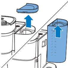
**1** Відкрийте кришку резервуара для води і вийміть резервуар із пристрою.
