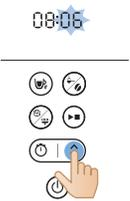
4 De minutenindicatie gaat knipperen. Gebruik de pijltjestoets om de minuten aan te passen.
