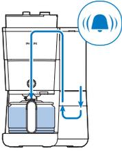
12 Odota, että keitin on suodattanut kalkinpoistoaineen.
