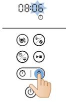
5 Vuelva a utilizar el botón de flecha para ajustar los minutos. Si necesita realizar un ajuste rápido, mantenga pulsado el botón de flecha.
