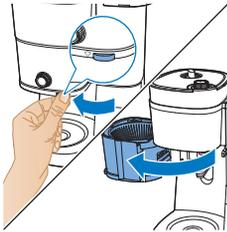
5 Lägg filtret i filterkorgen och stäng filterkorghållaren.
