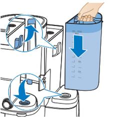
**3** Vuelva a colocar el depósito en el aparato.
