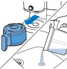
**14** Vacíe la jarra y retire el filtro permanente con los restos de cal.
