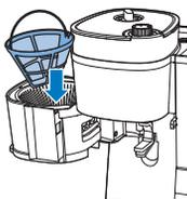
**3** Τοποθετήστε το φίλτρο στο καλάθι του φίλτρου.
