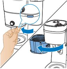
5 Aseta suodatin suodatinkoriin ja sulje suodatinkorin teline.
