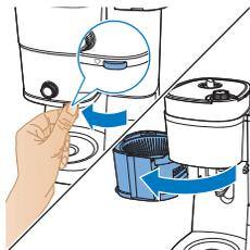
5 Namestite filter v košaro filtra in zaprite nosilec košare filtra.
