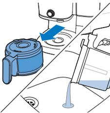
**14** Izpraznite vrč in odstranite trajni filter z ostanki vodnega kamna.
