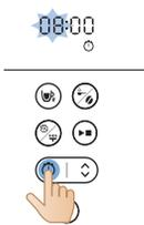
2 Drücken Sie die Timer-Taste. Das Timer-Symbol wird auf dem Display angezeigt. Die Ziffern der Stundenanzeige blinken, um das Einstellen der Stunde anzuzeigen.
