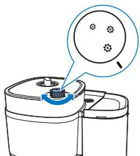
**9** С помощью регулятора выберите желаемый размер помола.
