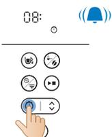
4 Drücken Sie die Timer-Taste, um die Stundeneinstellung zu bestätigen. Die Ziffern der Minutenanzeige geben die eingestellten Minuten an.
