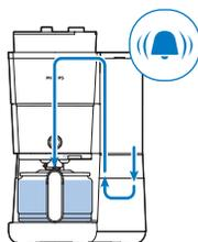
**12** Počkejte, až kávovar dokončí přípravu roztoku na odstraňování vodního kamene.
