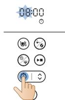
2 Нажмите кнопку таймера, и значок таймера появится на дисплее. Цифры часов начнут мигать, обозначая настройку значения часов для таймера.
