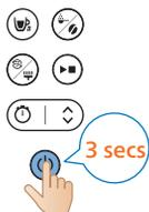
**22** Kako biste isključili aparat, pritisnite i zadržite gumb za uključivanje/isključivanje tri sekunde.
