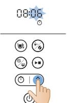
5 Utilizzare nuovamente il pulsante freccia per regolare i minuti. Se è necessaria una regolazione rapida, premere a lungo il pulsante freccia.
