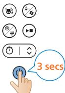
**15** Seadme väljalülitamiseks vajutage ja hoidke all toitenuppu kolm sekundit.
