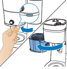
5 Filtreyi filtre sepetine yerleştirin ve filtre sepeti tutucusunu kapatın.
