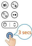
**15** Kako biste isključili aparat, pritisnite i zadržite gumb za uključivanje/isključivanje tri sekunde.
