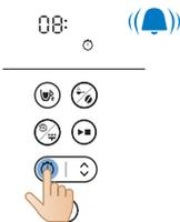
4 Prima o botão do temporizador para confirmar a definição das horas. Os dígitos dos minutos indicam que pode ajustar os minutos.
