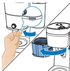
5 Placer filteret i filterkurven, og luk holderen til filterkurven.
