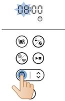
2 Prima o botão do temporizador e o ícone do temporizador aparecerá no visor. Os dígitos das horas ficam intermitentes para indicar que pode ajustar as horas.
