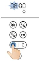
2 Apasă butonul de temporizare și pictograma temporizatorului va apărea pe afișaj. Cifrele orei luminează intermitent pentru a indica setarea orelor.
