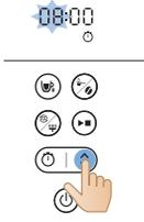
3 Utilizzare il pulsante freccia per regolare le ore. Se è necessaria una regolazione rapida, premere a lungo il pulsante freccia.
