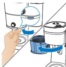
5 Stavite filter u korpu filtera i zatvorite držač nosača filtera.
