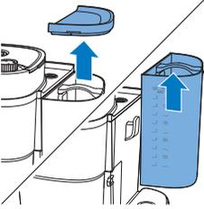
**1** Ouvrez le couvercle du réservoir d'eau et retirez-le de l'appareil.
