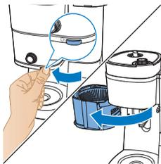
2 Åbn filterholderen for at få adgang kværnens tragtsliske.
