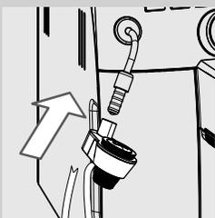
**27** Inserire il Montalatte Automatico sulla protezione in gomma fino allo scatto in posizione.
