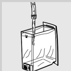
**4** Estrarre il serbatoio dell'acqua e versarvi l'intero contenuto del decalcificante Saeco. Riempire il serbatoio con acqua fresca fino al livello MAX.
