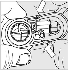
**24** Montare il Montalatte Automatico nel raccordo assicurandosi che sia ben fissato nella sua sede.
