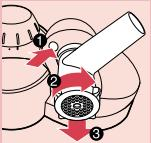
**4** Odvrnite pričvrsni navojni prsten, izvadite disk za mljevenje, nož te pužni prijenos.
