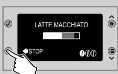
**8** Po končanem točenju mlečne pene, aparat iztoči kavo. Če želite točenje prej prekiniti, pritisnite tipko "汲".
