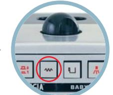
Wenn die Kontrolllampe erlischt, ist die Maschine zur Dampfabgabe bereit.
