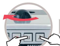
Dampfdruckknopf zum Beenden des Auffüllvorgangs schließen. Die Tasten drücken.
