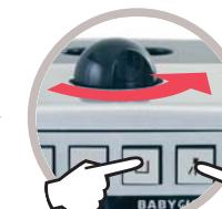
Ouvrir le robinet et presser les boutons pour charger le circuit.
