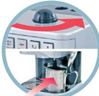
Plaats een recipiënt. Draai de knop open om het resterende water af te voeren.
