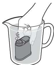
2 Переверните фильтр и поместите его в емкость с холодной водой. Дождитесь, пока из фильтра перестанут выделяться пузырьки воздуха.
