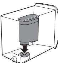
3 Извлеките резервуар для воды из кофемашины и установите фильтр в держатель в вертикальном положении.
