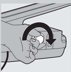
**9** Riavviate a fondo il tappo del sistema Calc-Clean sul generatore di vapore.
