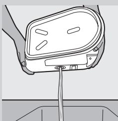
**7** Vuelva a vaciar el generador de vapor en el fregadero.
