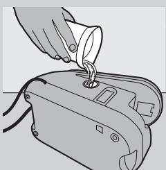
**6** Riempite il generatore di vapore con acqua pulita e scuotetelo nuovamente.
