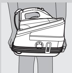
**6** Når du flytter apparatet, må du løfte det etter håndtakene på begge sider av dampgeneratoren.
