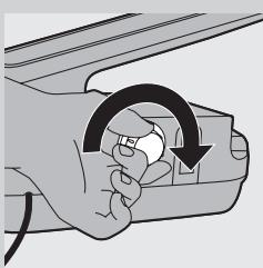
**9** Volte a apertar a tampa de enxaguar Calc-Clean no vaporizador.
