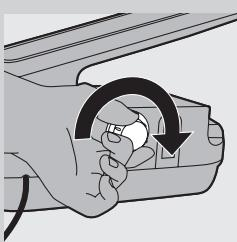
**9** Enrosque el tapón de limpieza Calc-Clean firmemente en el generador de vapor.
