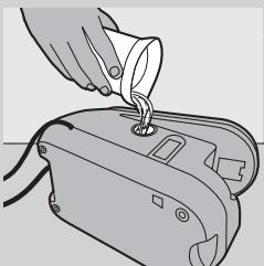
**6** Füllen Sie die Dampfeinheit mit frischem Wasser und schütteln Sie sie erneut.
