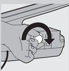
**9** Vissez fermement le bouchon Calc-Clean sur la chaudière.
