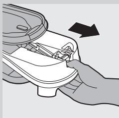
Nunca retire a tampa de enxaguar Calc-Clean com o vaporizador quente.
