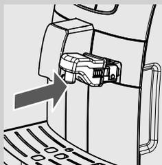
**1** Incline ligeiramente o distribuidor de água e introduza-o até ao fundo nas guias da máquina.
