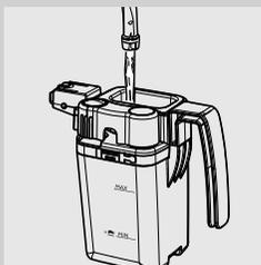
**4** Remova a parte superior e encha a jarra de leite com água fresca até ao nível MÁX.
