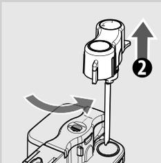
**13** Levante o distribuidor para o extrair da tampa da jarra. O distribuidor da jarra de leite é composto por seis peças que é necessário desmontar. Cada peça individual é identificada pelas letras maiúsculas (A-E) ilustradas de seguida nas imagens relativas às várias fases.
