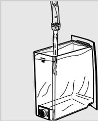
**18** Quando o reservatório de água estiver vazio, remova-o da máquina. Enxágue-o e encha-o com água fresca até ao nível MÁX. Reposicione o reservatório de água na máquina.
