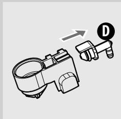
18 Retire a junção (D) do emulsificador do leite extraindo em direcção ao exterior.
