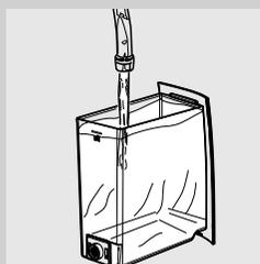
**14** Extraia o reservatório de água, enxágue-o e volte a enchê-lo com água fresca até ao nível MÁX. Reintroduza-o na máquina.
