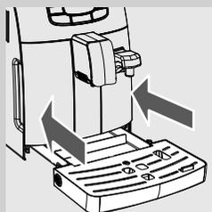
**4** Introduza a bandeja de limpeza com grelha na máquina. Verificar que seja totalmente inserida.
