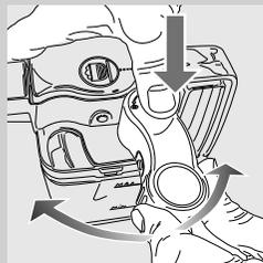
**2** Pressione com força na junta de rotação rodando-a, pelo menos, duas ou três vezes a um ângulo de 45°, conforme ilustrado na figura.
