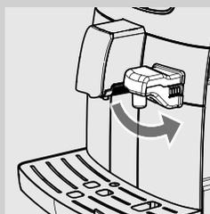
**2** Pressione e rode o distribuidor de água em direcção à parte inferior até o engatar na máquina conforme mostrado na figura.
