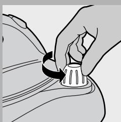
**2** Отвийте бавно капачката на парния резервоар.
