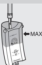
**1** Encha o reservatório com água fria até à indicação **MAX** e volte a colocá-lo na máquina.
