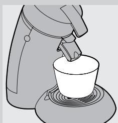
**8** Coloque un recipiente con capacidad para al menos 1,5 litros bajo la boquilla de salida del café para recoger el agua.
