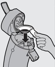
**2** Coloque o manípulo para 1 chávena ou o manípulo para 2 chávenas na máquina sem saquetas.
