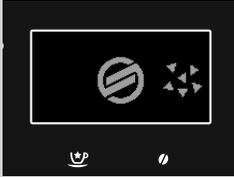
사용 중에 커피 머신 내부에 스케일이 축적됩니다. 스케일을 정기적으로 제거해 주어야 물 통로와 커피 통로가 막히는 것을 방지할 수 있습니다. 스케일 제거가 필요한 경우를 커피 머신에 표시됩니다. 커피 머신에 이 아이콘이 표시되면 스케일 제거를 해야 할 때가 된 것입니다.
