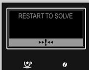
제어판 화면 아래쪽에 표시된 코드(E xx)를 기록해 두십시오. 커피 머신을 끄고 30초 후에 다시 켜십시오. 2~3회 반복합니다. 커피 머신이 시작되지 않으면 해당 국가의 필립스 세코 직통 전화로 연락하여 화면에 표시된 코드를 알려주십시오. 별도로 포장된 보증 책자 또는 [www.philips.com/support](http://www.philips.com/support)에서 연락처 정보를 찾아 볼 수 있습니다.
