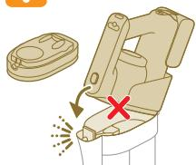
**⚠ 警告：**当集尘桶中没有装入滤网盒时，请勿将手持设备与集尘桶重新连接。
