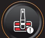
i3   | 双刷吸嘴被卡住。这是一个安全保护装置，如果有异物（例如，电缆或玩具）卡在吸嘴中，会切断电源。        | 检查毛刷、轴承、马达部件和盖子上是否有毛发或其他障碍物，并将其清除。如果没有障碍物，关闭并重启产品可能会解决此问题。                                                      |
