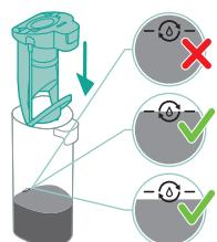
**i 注意:** 如果污水水位低于 每次使用后执行 自动清洁 水位，无需在启动 自动清洁 程序之前清空水箱。可跳过以下步骤，前进到第 6 步。
