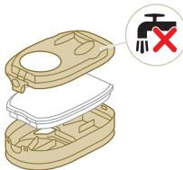
2 按下拆卸按钮，拆下滤网盒的盖子并取下海绵滤网。
