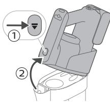
**1** 按下拆卸按钮 (1) 拆下集尘桶的手持设备，然后将手持设备从产品上提起 (2)。
