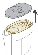
**⚠ 警告：** 组装仅吸尘装置前，确保已从手持设备上取下保护盖。
