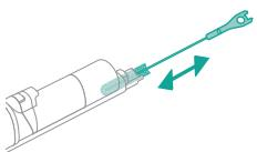
如果洗地模块堵塞，请先关闭产品并取下双刷吸嘴和手持设备。然后，在洗地模块的吸入通道中上下移动清洁刷来清除堵塞物。
