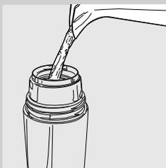
**2** Die Milch in den Thermobehälter füllen. Der Füllstand sollte zwischen den Angaben MIN und MAX liegen.
