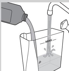
**3** Versez le contenu d'un flacon de solution de détartrage Philips SENSEO® SARISTA (250 ml) dans le réservoir d'eau, puis ajoutez 1 litre d'eau du robinet pour remplir le réservoir d'eau jusqu'à l'indication MAX.
