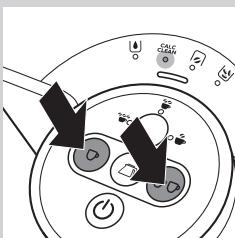
8 Druk gedurende één seconde tegelijkertijd op de 1-kops knop en de 2-kops knop om de ontkalkingsprocedure te beginnen.
