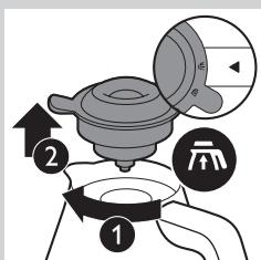
**1** Ontgrendel het deksel door de hendel naar het verwijdersymbool te draaien. Trek het deksel vervolgens van de kan.
