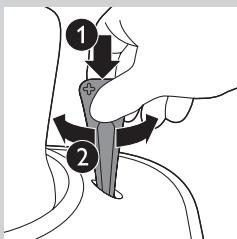
De instelling van de molen kan na verloop van tijd veranderen in een grovere maling. Het wordt aangeraden de malsterkte in te stellen wanneer u dit opmerkt. Deze aanpassingen zijn niet regelmatig vereist.
