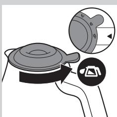
**Opmerking:** Om de koffie in de kan warm te houden, draait u het deksel altijd meteen na het uitschenken van de koffie naar de stand 'gesloten/koffiezetten'.
