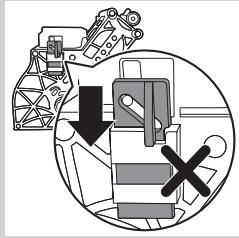
**9** Assurez-vous que le crochet pour le blocage du groupe café est dans la bonne position. Le crochet n'est pas correctement positionné s'il est toujours dans la position la plus basse.
