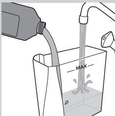
3 Giet de inhoud van een flesje Philips SENSEO® SARISTA-ontkalkoplossing (250 ml) in het waterreservoir en voeg vervolgens 1 liter kraanwater toe om het waterreservoir te vullen tot de MAX-aanduiding.
