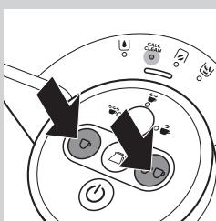
**8** Appuyez sur le bouton pour 1 tasse et sur le bouton pour 2 tasses simultanément pendant 1 seconde pour démarrer la procédure de détartrage.
