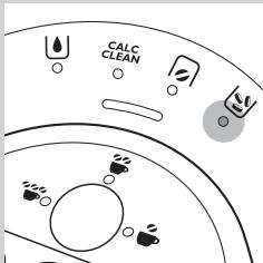
**Opmerking:** Als u de koffiedikbak niet leegt, kan het 'koffiedikbak vol'-lampje gaan branden en kan de koffiezetter tijdens het koffiezetten stoppen. Zorg ervoor dat het apparaat ingeschakeld is wanneer u de koffiedikbak leegt. Neem de bak 3 seconden uit het apparaat tot het 'bean-funnel leeg'-lampje stopt met knipperen voordat u de bak terugplaast. Druk op de kanknop om verder te gaan met koffiezetten.
