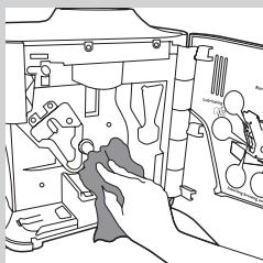
**7** Nettoyez soigneusement l'intérieur de la machine à café avec un chiffon humide.
