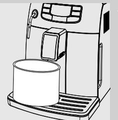
**8** Posizionare un contenitore capiente (1,5 l) sotto il tubo vapore/acqua calda e sotto l'erogatore.
