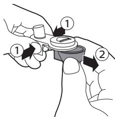
**4** Чтобы снять автоматический вспениватель молока, нажмите на его боковые стороны (1) и потяните, слегка покачивая из стороны в сторону (2).
