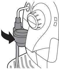
**2** Поверните трубку выхода горячей воды/пара с автоматическим вспенивателем молока по направлению к кофемашине так, чтобы вспениватель принял горизонтальное положение и соприкоснулся с кофемашиной.
