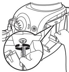
**5** Очистите выходное отверстие для кофе при помощи ручки ложки или другой кухонной принадлежности с закругленным наконечником.
