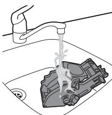
**7** Сполосніть зовнішню частину блока заварювання теплою проточною водою.
