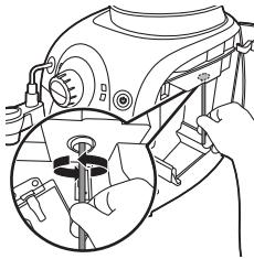
**5** Ретельно почистьте сопло виходу кави за допомогою ручки ложки або іншого кухонного приладдя з круглим кінцем.
