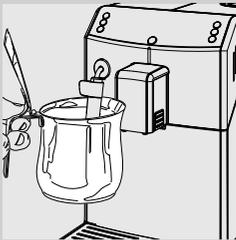
**6** Positionner un récipient sous le Mousseur à lait Classique.
