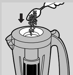
**4** Puneți ingredientele în filtru prin deschizătura din capac. Nu umpleți niciodată filtrul mai sus de componenta metalică. Nu utilizați filtrul pentru a procesa ingrediente fierbinți.
