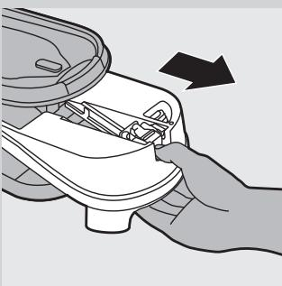
Не отваряйте капачето за промиване на системата за почистване на накип, докато парният генератор е горещ.
