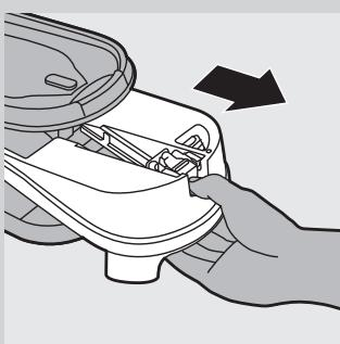
Pokial' je generátor pary horúci, nikdy neodpájajte vyplachovací uzáver na odstraňovanie vodného kameňa.
