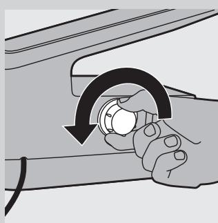
**4** Pakreipkite garų generatorių ant šono su kalkių valymo skalavimo dangteliu, pasuktu į viršų, ir nuimkite kalkių valymo skalavimo dangtelį.
