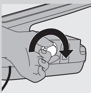
**9** Cieši aizskrūvējiet Calc-Clean skalošanas vāku uz tvaika ģeneratora.
