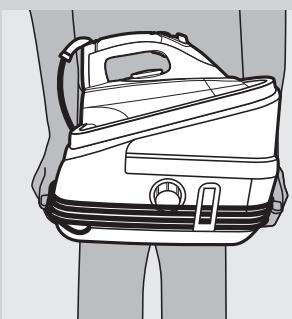
**5** Přístrojem pohybujte pomocí rukojetí na obou stranách generátoru páry.
