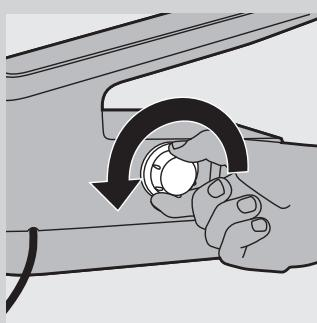
**4** Generátor páry položte na boční stranu tak, aby uzávěr vyplachování Calc-Clean směřoval nahoru a vyjměte uzávěr vyplachování Calc-Clean.
