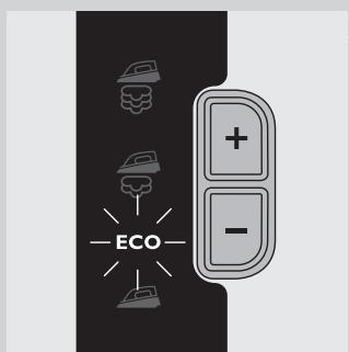
**4** Z gumboma + in - na nadzorni plošči generatorja pare nastavite ustrezno nastavitev za paro.
