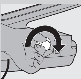
**9** Щільно закріть генератор пари промивною кришкою Calc-Clean.
