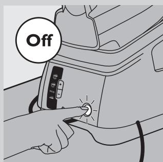
**1** Novietojiet gludekli uz gludināšanas statīva (skatiet nodaļu ‘Glabāšana’) un izslēdziet ierīci.
