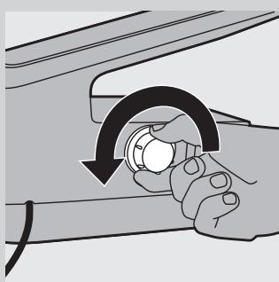
**4** Întoarceți generatorul de abur pe o parte, cu capacul de clătire pentru detartrare îndreptat în sus și scoateți capacul de clătire pentru detartrare
