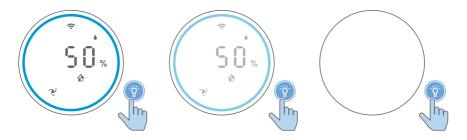
Grâce au détecteur de luminosité, le panneau de commande s'allume, s'éteint et réduit sa luminosité automatiquement, en fonction de l'éclairage de la pièce. Le panneau de commande s'éteint ou réduit sa luminosité lorsqu'il fait sombre. Vous pouvez appuyer sur n'importe quel bouton pour allumer tous les voyants et vérifier la qualité de l'air. Ensuite, si aucune autre action n'est réalisée, tous les voyants s'éteignent ou réduisent leur luminosité afin de s'adapter à la luminosité de la pièce.
