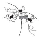
4 拆除自動奶泡機時,請按住側邊 (1)稍微左右移動拉出 (2)。
