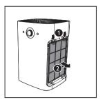
**4** 将拆去包装的空气净化滤网放回 产品内。
