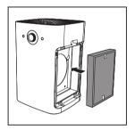
**5** 将预过滤网正确放回产品后,重置 滤网使用寿命计数器。
