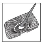
**3** 要重新安装出风口盖,请先将一侧 装到产品顶部,然后将手柄一侧向 下推动。
