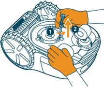
3 Rimuovere ogni lama e vite e sostituirla con quelle nuove.
