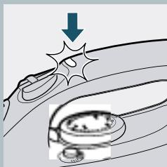
Otomatik Kapanma özelliği bulunan modeller için. (Sadece GC4043, GC4040, GC4038, GC4035, GC4033, GC4030 içindir)
