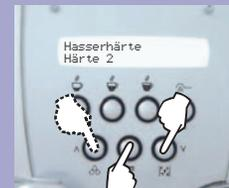
Entsprechenden Härtegrad anwählen (z.B. 2 Quadrate = Härte 2) und mit der OK-Taste speichern.
