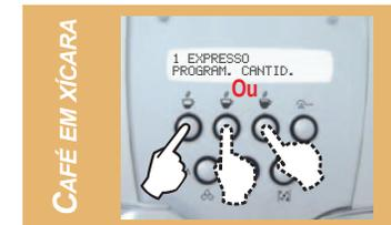
Colocar a xícara abaixo do fornecedor, pressionar a tecla de fornecimento do tipo de café desejado e **mantê-la pressionada durante todo o processo de fornecimento do café.**
