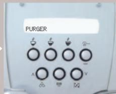
L'afficheur indique que le circuit de la machine doit être amorcé.
