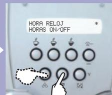
Seleccionar mediante los botones "∧" y "∨" y activar con el botón "OK" para programar el reloj.
