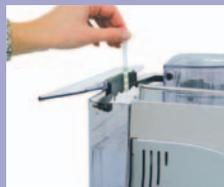
La machine est programmée sur une valeur de dureté de 3. La dureté de l'eau devrait être réglée suivant la quantité de calcaire contenue et de la dureté de l'eau.
