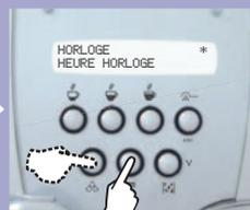
Menu pour activer l'heure de mise sous tension et hors tension de la machine.
