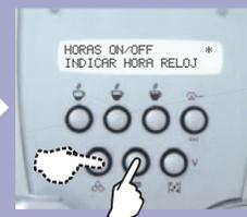
Menú para programar los horarios de encendido y apagado de la máquina.
