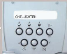
Het display geeft aan dat het circuit van het apparaat gevuld moet worden.
