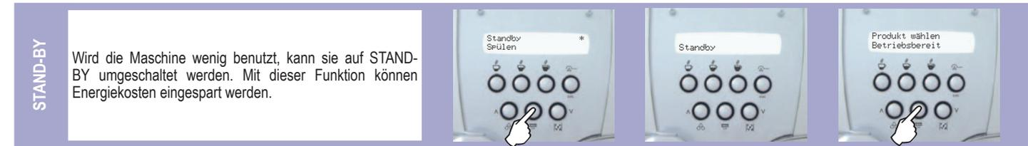
Wird die Maschine wenig benutzt, kann sie auf STAND-BY umgeschaltet werden. Mit dieser Funktion können Energiekosten eingespart werden.
