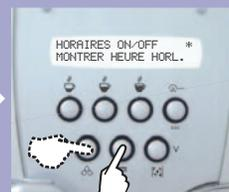
Menu pour programmer l'heure de mise sous tension et hors tension de la machine.
