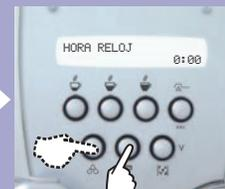
Programar la hora mediante los botones "∧" y "∨" y presionar "OK"; programar los minutos con los botones "∧" y "∨" y presionar "OK".
