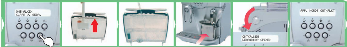
Druk 5 seconden op de knop wanneer het apparaat dit aangeeft.
