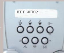
Het display geeft aan dat het circuit van het apparaat gevuld is.
