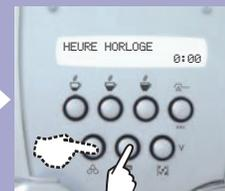
Programmer l'heure avec les touches «^» et «v» puis valider avec «OK». Programmer les minutes avec les touches «^» et «v» puis valider avec «OK».
