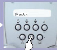
Erscheint, wenn sich die Maschine in einer OFF-Zeit befindet. Zur Aktivierung "OK" drücken.
