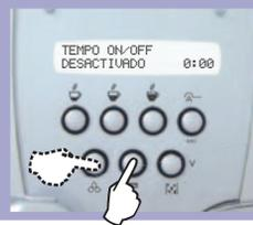
Ajustar o horário de desligamento da máquina.
