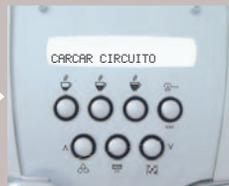
El monitor indica que es necesario cargar el circuito de la máquina.
