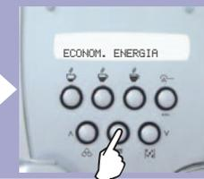
Aparece cuando la máquina está en horario OFF. Presionar "OK" para activar.
