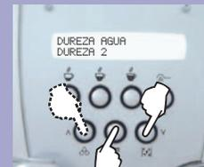
Elegir el grado de dureza correspondiente (por ej. 2 cuadrados = Dureza 2) y memorizar con el botón "OK".
