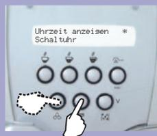
Mit den Tasten "∧" und "∨" auswählen und mit der Taste "OK" zur Anzeige der Uhrzeit aktivieren.
