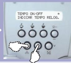
Menu para ajustar os horários de ligação e desligamento da máquina.
