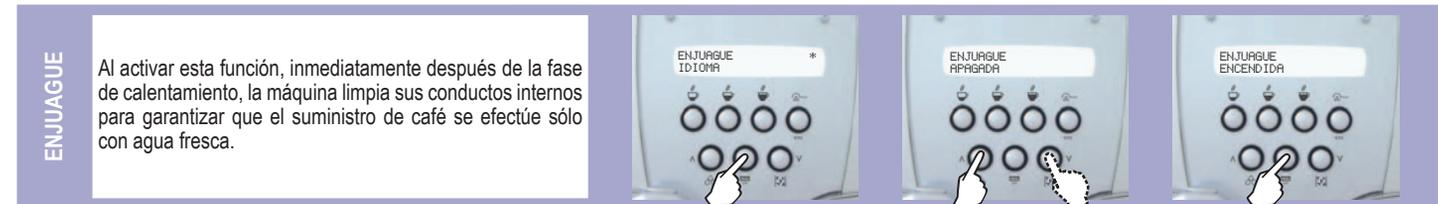
Al activar esta función, inmediatamente después de la fase de calentamiento, la máquina limpia sus conductos internos para garantizar que el suministro de café se efectúe sólo con agua fresca.
