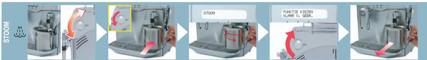
Open de kraan om het resterende water te verwijderen. Sluit de kraan.
