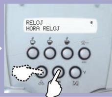
Menú para activar los horarios de encendido y apagado.
