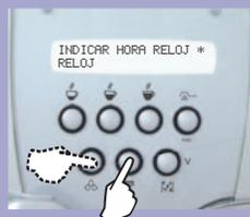
Seleccionar mediante los botones "∧" y "∨" y activar con el botón "OK" para visualizar el reloj.
