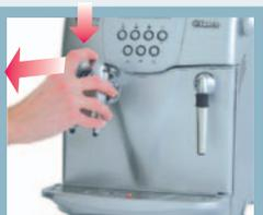
Auslauf abmontieren und mit Wasser waschen.
