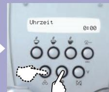
Mit den Tasten "∧" und "∨" die Stunde einstellen und "OK" drücken; mit den Tasten "∧" und "∨" die Minuten einstellen und "OK" drücken.
