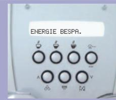
Het display geeft aan dat het apparaat op energiebesparing staat.
