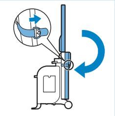
**1** Klap de strijkplank in de opbergstand en vergrendel de plank met de vergrendelband.
