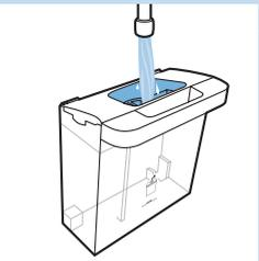
**3** Llene el depósito de agua con agua del grifo normal y colóquelo en el aparato.
