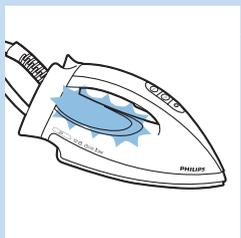
**6** El piloto de “plancha lista” parpadea para indicar que el dispositivo se está calentando.
