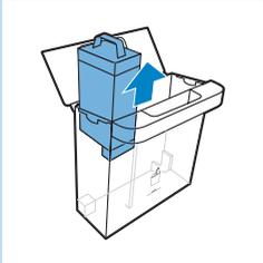
**2** Nehmen Sie die Anti-Kalk-Kartusche aus dem Wasserbehälter, und entsorgen Sie sie.
