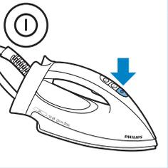
**8** Buhar üreticisini etkinleştirmek için ütünün güç açma düğmesine basın.
