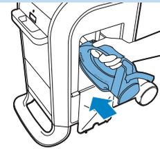
**13** Puede guardar la plancha caliente en el compartimento resistente al calor inmediatamente después de apagarla.
