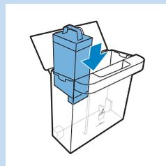
**4** Rimuovete l'imballaggio e posizionate la nuova cartuccia anticalcare nel serbatoio dell'acqua.
