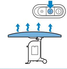
**10** Si vous souhaitez utiliser la fonction soufflante, appuyez sur le bouton de soufflerie situé sur le fer.
