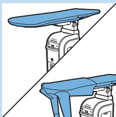
**12** Per risultati ottimali quando si stirano le camicie potete utilizzare la parte dell'asse conformata. Questa estremità consente una stiratura più semplice senza dover girare più volte l'indumento.
