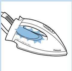
6 Het 'strijkijzer gereed'-lampje begint te knipperen om aan te geven dat het apparaat bezig is met opwarmen.
