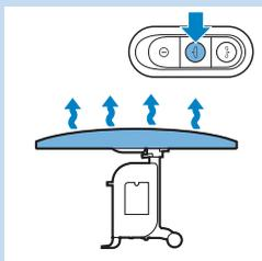
**10** Se desiderate stirare utilizzando la modalità soffio d'aria dell'asse da stiro, premete il pulsante relativo sul ferro da stiro.
