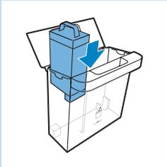
**4** Entfernen Sie die Verpackung, und setzen Sie die neue Anti-Kalk-Kartusche in den Wasserbehälter ein.
