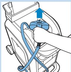
**6** Retire o vaporizador do compartimento do vaporizador.
