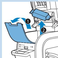
**3** Aprite il coperchio del vano di riposizionamento del vaporizzatore (1) ed estraete la cartuccia anticalcare (2).
