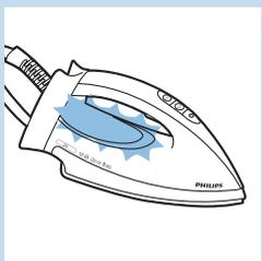
**6** Le témoin « Fer prêt » se met à clignoter pour indiquer que l'appareil monte en température.
