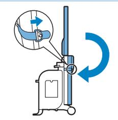
**2** Lossa spärrbygeln och fäll ut strykrädan till vertikalt läge.
