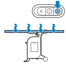
**11** Si desea planchar con el modo de succión de la tabla, pulse el botón de succión de la plancha.
