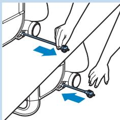
**2** Zum Aufrollen des Netzkabels ziehen Sie kurz daran, und lassen Sie es anschließend wieder los. Das Kabel wickelt sich automatisch auf.
