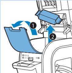
**3** Öffnen Sie den Deckel des Aufbewahrungsfachs für die Dampfeinheit, und nehmen Sie die neue Anti-Kalk-Kartusche heraus.
