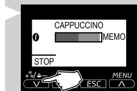
وبذلك تمت برمجة الزر "CAPPUCCINO". في كل مرة يتم فيها الضغط على هذا الزر ، سيعضر الجهاز نفس المقدار الذي تم ضبطه توا.
