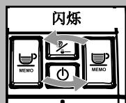
将排出少量的水，以冲洗并加热咖啡机组件；在此阶段中，“”和“”按钮将交替闪烁。
