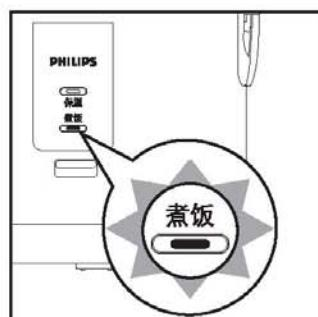
(2) 待水沸腾后，需手动挑起控制键，此时“保温”功能指示灯亮，可立即拔掉电源插头。
