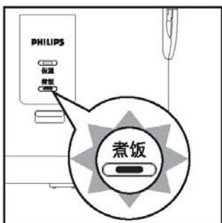
(2) 蒸食完成后，需手动挑起控制键，此时“煮饭”功能指示灯灭，“保温”功能指示灯亮，表示已进入保温工作状态。
