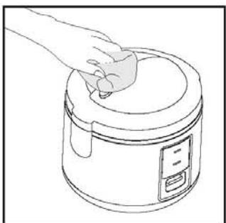
(2) 锅盖内侧的脏污如不及时洗涤，脏污将粘附到内侧面上，很难洗掉，所以每次使用后要擦拭干净。
