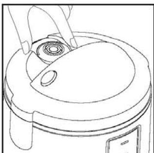
(2) 把蒸汽阀盖旋到开盖位置，拆开蒸汽阀。
