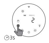
按住濾網狀態檢查/重設按鈕3秒,以重新設定濾網更換時間。
