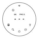
正準備運作時,「---」將顯示在螢幕上。 在測量空氣質素後,空氣清新機會顯示 IAI/ PM2.5 水平。
