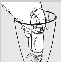
**2** Den Wasserfilter “INTENZA+” aus der Verpackung herausnehmen und senkrecht (so dass die Öffnung nach oben zeigt) in kaltes Wasser tauchen. Den Filter leicht an den Seiten zusammendrücken, um die Luftblasen zu entfernen.
