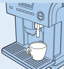
**3** Tryck på knappen för varmt vatten tills meddelandet PROGRAM FÖR INSTÄLL. - VARMT VATTEN visas i teckenfönstret och släpp sedan knappen.
