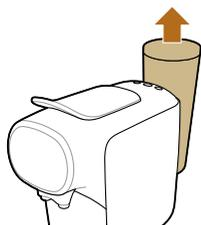
**2** Öblítse ki a víztartályt a csap alatt, és tölte meg. Helyezze vissza a víztartályt a készülékbe.
