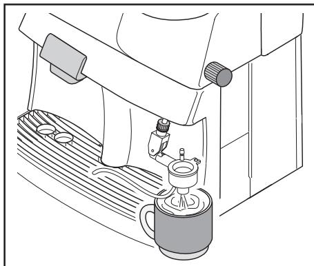
Il tubo in silicone posto installato nel cappuccinatore, durante l'erogazione dell'acqua calda, deve essere inserito nella griglia della vasca raccogligocce. Assicurarsi che il tubo in silicone non abbia possibilità di sfilarsi durante l'utilizzo della macchina.
