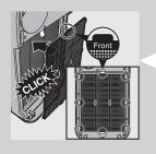
4 將預過濾網裝回產品中。將所有扣鉤正確扣入產品。
