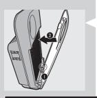
**6** 若要重新裝入正面護板,先將底部扣鉤裝入產品底部 (1)。 然後將護板推入產品機體 (2)。
