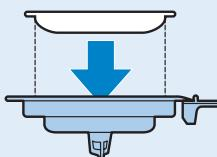
*Hinweis:* Achten Sie darauf, dass der Kaffee im Pad bzw. in den Pads gleichmäßig verteilt ist, und drücken Sie das Pad (die Pads) im Padhalter leicht an.
