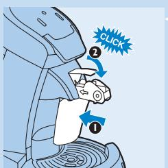
**6** Schuif de melkreservoirunit in de koffiemachine (1) en druk de melkreservoirhendel omlaag ('klik') (2).
