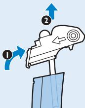
**1** Druk op de ontgrendelhendel van het melkreservoirdeksel (1) en verwijder het melkreservoirdeksel van het melkreservoir (2).
