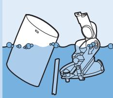
**4** Maak het melkreservoir, het melkreservoirdeksel en de melkbuis schoon in de vaatwasmachine of met een afwasborstel in warm water met een beetje afwasmiddel. Spoel de onderdelen na met schoon water.
