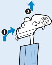
**1** Appuyez sur le levier de déverrouillage du couvercle du réservoir de lait (1) et retirez le couvercle (2).
