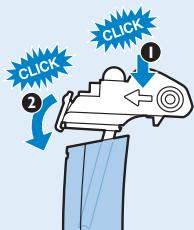
**5** Pour fixer correctement le couvercle sur le réservoir de lait, mettez d'abord en place l'avant du couvercle sur le réservoir (« clic ») (1), puis appuyez sur l'arrière (« clic ») (2).
