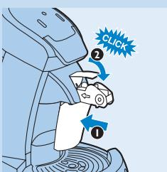
**6** Insérez l'unité du réservoir de lait dans la cafetière (1) et abaissez le levier du réservoir de lait (« clic ») (2).
