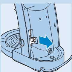
**5** Insérez le système anticalcaire dans l'unité d'écoulement du café.
