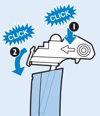
**5** Om het melkreservoirdeksel op het melkreservoir te bevestigen, drukt u eerst de voorkant van het deksel op de rand van het melkreservoir ('klik') (1) en dan drukt u de achterkant op het melkreservoir ('klik') (2).
