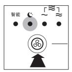
To change to another fan speed, press the fan speed button <sup>®</sup>.
