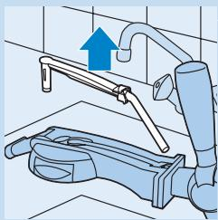
**7** Tirez le connecteur du tuyau hors du robinet et retirez le tuyau souple.
