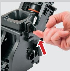
**11** Proverite da li je kuka za blokiranje bloka za pripremu kafe u pravilnom položaju. Ako je još uvek u spuštenom položaju, podignite je prema gore dok je ne zakačite pravilno.
