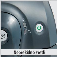
Pre ispuštanja kafe, proverite da li zelena led lampica "⊕" svetli neprekidno, da li su rezervoar za vodu i posuda za kafu puni.
