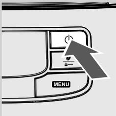
**13** Um das Gerät einzuschalten, muss lediglich die Taste "⏻" gedrückt werden. Das Display zeigt an, dass die Entlüftung des Systems vorgenommen werden muss.
