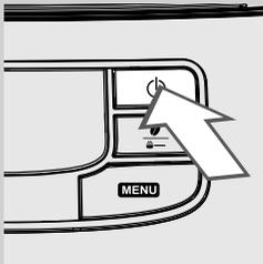
**9** Den Stecker des Netzkabels erneut in die Wandsteckdose einstecken. Das Gerät durch Drücken der Taste "☕" einschalten. Abwarten, bis der automatische Spülzyklus beendet ist.
