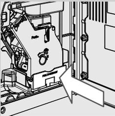
**12** Nach der Spülung der Brühgruppe wird diese wieder in die Aufnahme eingesetzt, bis sie in der korrekten Position einrastet (siehe Kapitel "Wöchentliche Reinigung der Brühgruppe"). Den Kaffeeauffangbehälter und den Kaffeesatzbehälter einsetzen. Die Servicetür schließen.
