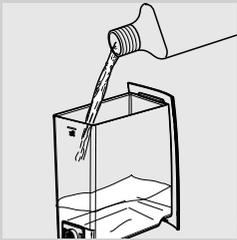
**6** Den Wassertank herausnehmen und den gesamten Inhalt des Entkalkers Saeco einfüllen. Den Wassertank bis zum Füllstand MAX mit frischem Wasser füllen.
