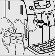
4 Den Ansaugschlauch in den Milchbehälter einstecken.
