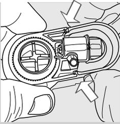
**24** Den automatischen Milchaufschäumer auf dem Anschluss montieren, und sicherstellen, dass er in seiner Aufnahme korrekt befestigt wurde.
