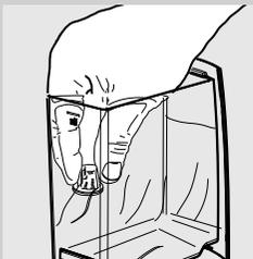
**1** Den kleinen weißen Filter aus dem Wassertank herausnehmen und an einem trockenen Ort aufbewahren.
