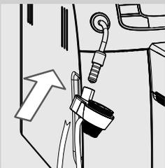
**27** Den automatischen Milchaufschäumer in den Gummischutz einstecken, bis er einrastet.
