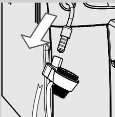
**17** Den automatischen Milchaufschäumer aus dem Gerät herausnehmen.
