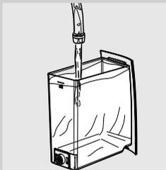
**12** Den Wassertank herausnehmen, ausspülen und bis zum Füllstand MAX mit frischem Wasser füllen. Wieder in das Gerät einsetzen.
