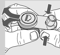
**20** Für die Abnahme des automatischen Milchaufschäumers wird auf die Seiten gedrückt und der Milchaufschäumer mit leicht seitlichen Bewegungen herausgenommen, wie in der Abbildung gezeigt.
