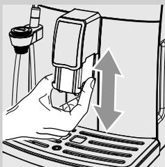
Für diese Einstellung wird der Auslauf von Hand nach oben oder nach unten geschoben, wie in der Abbildung gezeigt.
