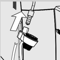
**7** Den automatischen Milchaufschäumer in die Aufnahme der Dampfdüse einstecken, bis er einrastet.
