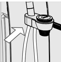
**11** Nach der Verwendung kann der Ansaugschlauch wieder angebracht werden, wie in der Abbildung gezeigt.
